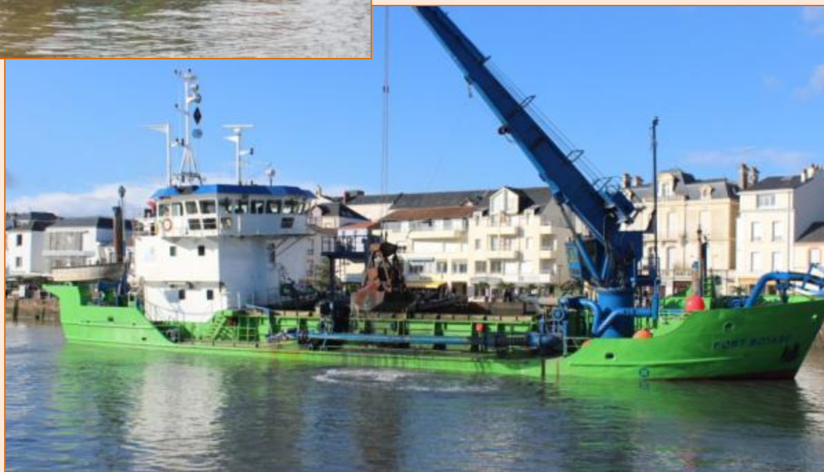
Dragage à la Benne Preneuse FORT BOYARD - 2019
